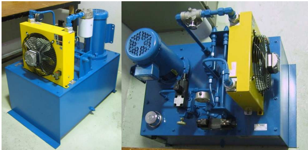
Figura 4. Vistas de la unidad de potencia del sistema hidráulico.
