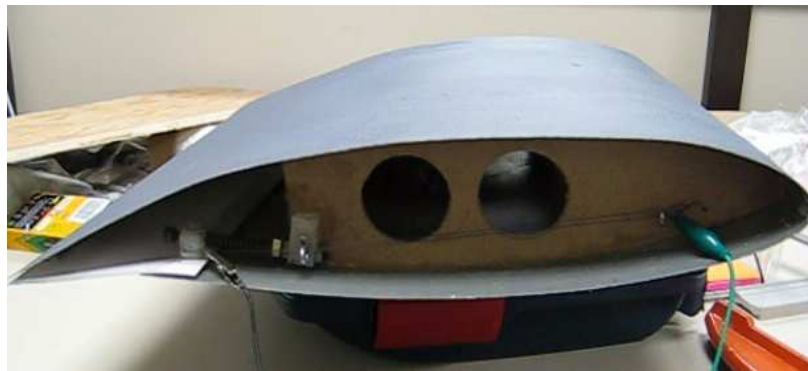
Fig. 8. Prototipo terminado, mostrando la deflexión del borde de salida.
