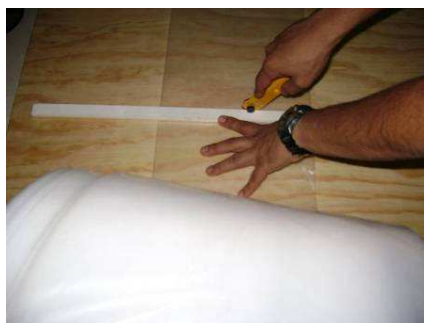
Figura 2. Proceso manual de corte de la bobina de polietileno
