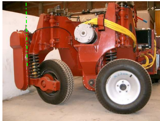
Fig. 2. Vista frontal del vehículo en posición de viraje a 90° hacia la izquierda, que muestra las dos flechas de viraje con sus líneas de centro resaltadas en verde. Se aprecia la gran masa combinada de los bastidores y de las unidades de propulsión, y además, también se aprecia el descentramiento de la misma respecto a las flechas de viraje.
