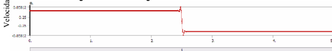
Figura 22. Velocidad angular del eslabón del lado izquierdo
