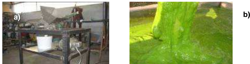
Figura 6. a) Vista lateral del prototipo de molino de corte radial y b) la pasta granulada.
