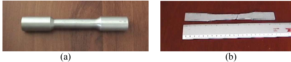
Fig. 3. Probetas utilizadas para las pruebas de compresión: a) probeta circular estándar de aluminio, b) probeta rectangular estándar de acero aluminizado.
