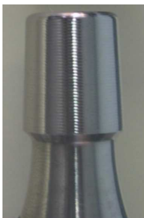
Figura 5 Rayado en el cuello femoral modular.
