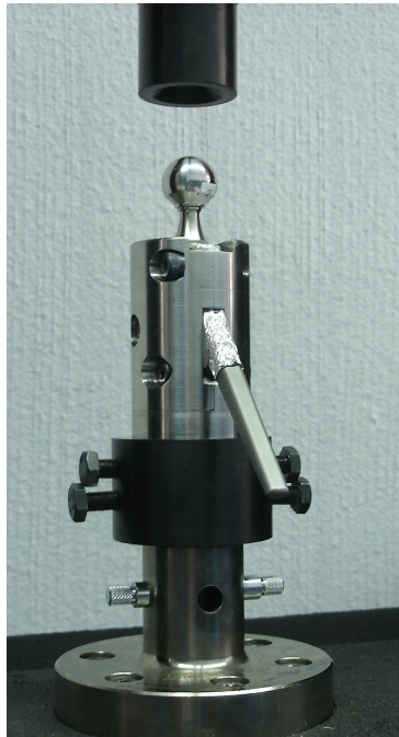
Figura 6. Montaje de dispositivos y vástagos en la maquina Instron para prueba del Ensamble.
