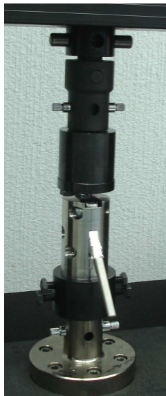
Figura 7. Montaje de dispositivos y vástagos en la maquina Instron para prueba del Desensamble.
