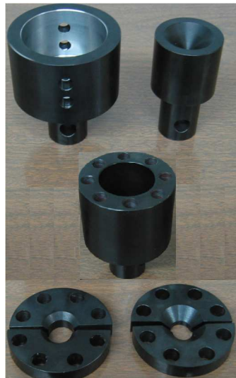
Figura 4. Dispositivos fabricados para realizar la prueba de ensamble en la maquina universal.
